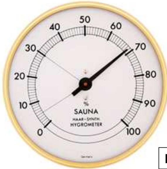
A medida da umidade do ar é feita por meio de higrômetros. O higrômetro de cabelo se baseia na propriedade de um fio de cabelo variar seu comprimento em função da umidade relativa do ar.
