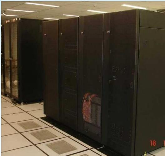
**Supercomputador IBM** na **USP**: 112 blades com 2 CPU's dual-core PowerPC 970 de 2.5GHz, rede Myrinet, cerca de **4.5 Tflops peak**, **posição 363** no *TOP500* (Novembro de 2006)
