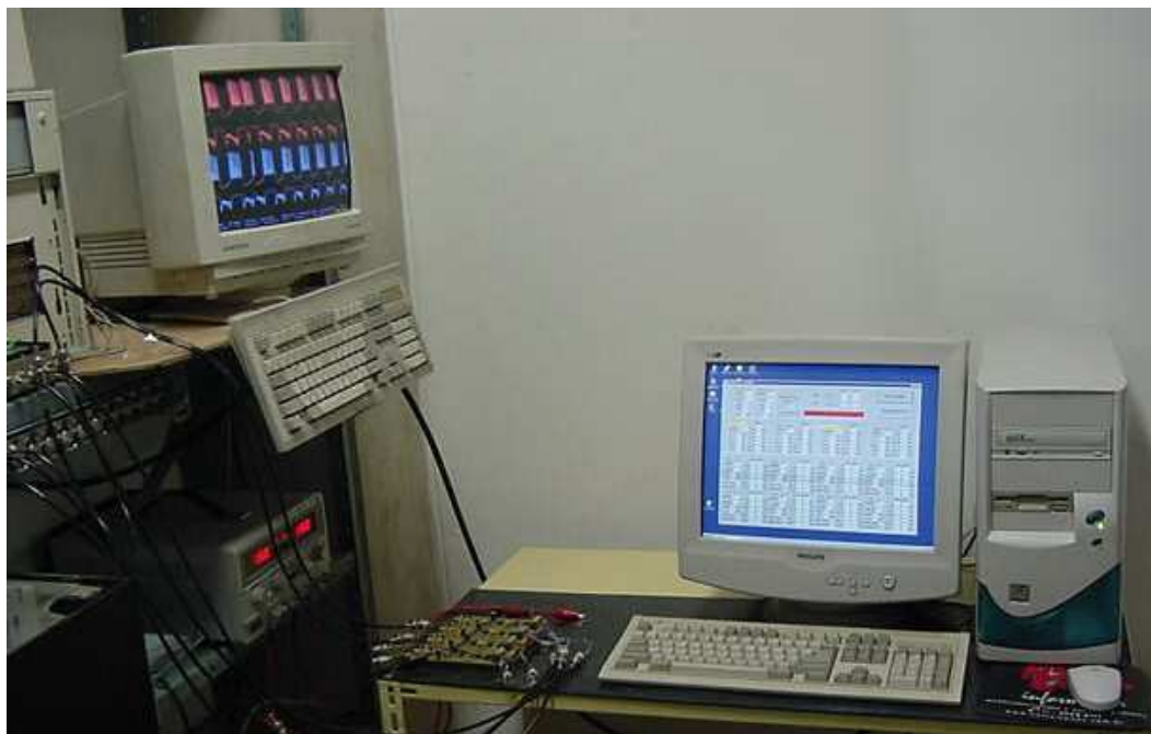
Figura 4.1: O primeiro aparato experimental: neurônios-modelo eletrônicos conectados ao programa Dynamic Clamp e a monitoração do comportamento dinâmico em um osciloscópio simulado em outro computador.
