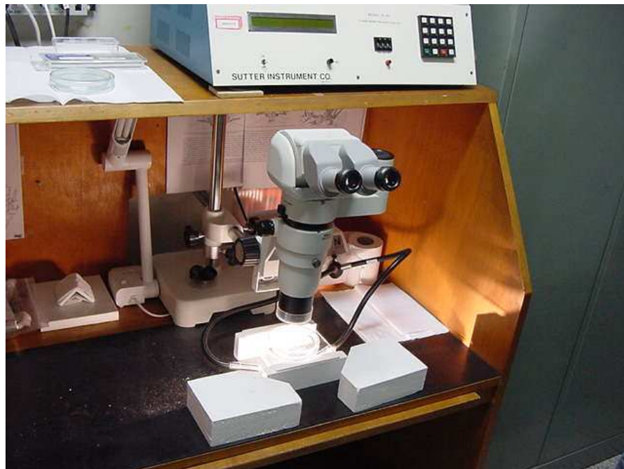
Figura 4.4: Mesa de dissecação. Após a retirada do estômago do siri um microscópio estereoscópico com ganho óptico máximo de 100X é usado para observar o sistema nervoso estomatogástrico durante sua limpeza e remoção do estômago e durante a microcirurgia que expõe os corpos celulares do STG.
