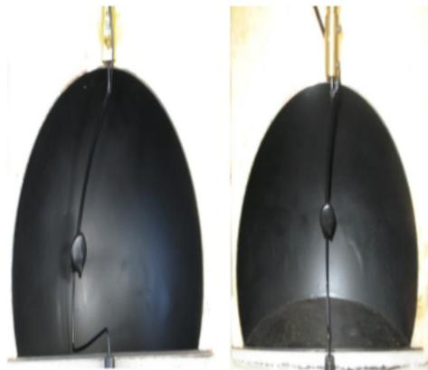
Figura 22 - Foto do estímulo. Resistência circular acoplada no meio de arco de alumínio, dentro da cúpula de cobre (Todos devidamente pintados com tinta fosca preta).
