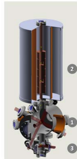
Relógio atômico tipo fonte de átomos. (1) Região de resfriamento de átomos; (2) Interação com micro-ondas; (3) Detecção de átomos.
