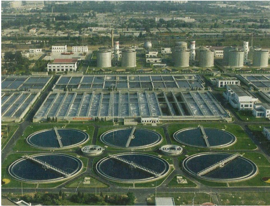
Figura 12 – Exemplo de um Sistema de Lodos Ativados Convencional (Fonte: IWA – International Water Association UK – 2006 World Water Congress & Exhibition – Folder)
