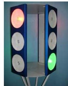
Protótipo de semáforo de alta eficiência usando LEDs
