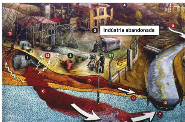
Figura 1: Fonte de contaminação do solo e águas subterrâneas – área industrial abandonada. Fonte: AHU, Consultoria em Hidrogeologia e Meio Ambiente, Alemanha, 1987, in CETESB, 2001.
