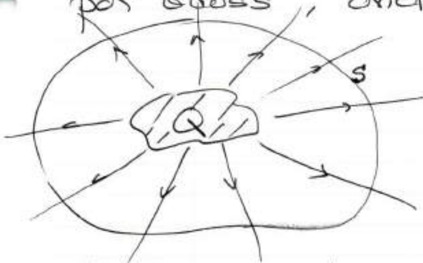
Fig II.7 - Carga elétrica, linhas de campo e fluxo do campo elétrico.
