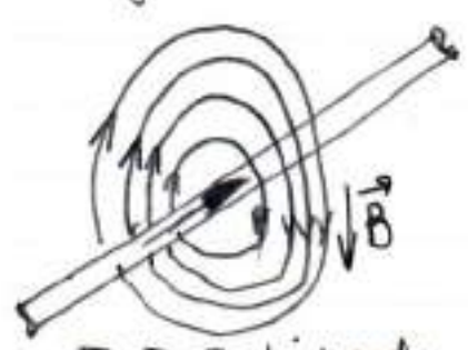
Fig II.8. Linhas de campo magnético ao redor de uma corrente.
