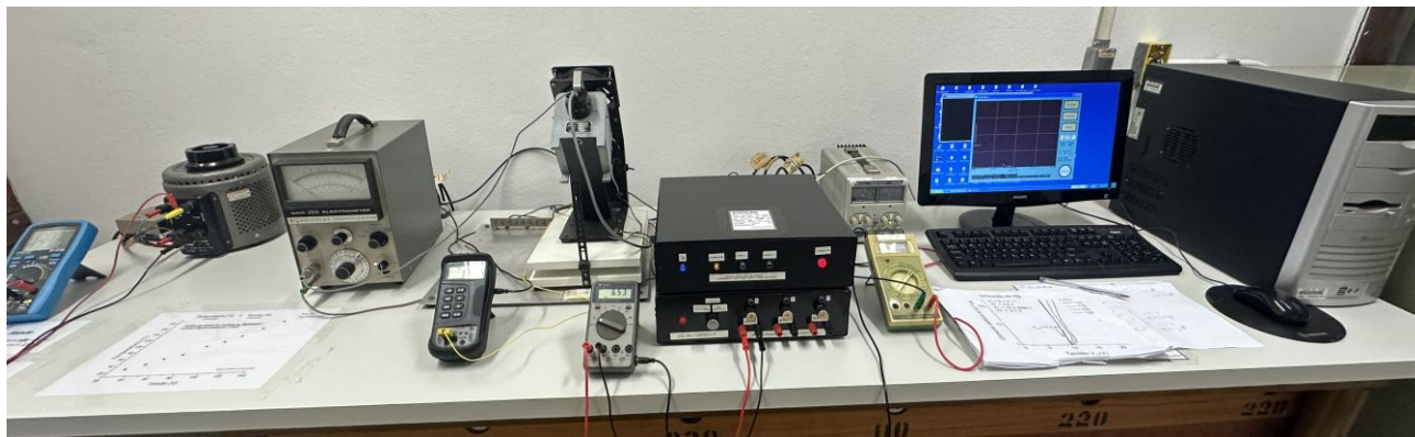
Figura 2 - Visão geral do experimento, da esquerda para direita, multímetro de controle da tensão de saída do Varivolt, Varivolt, eletrômetro, multímetro de leitura de temperatura da válvula, válvula e ventoinha, interface de controle e multímetro para ajuste das tensões ( V_1 , V_2 e V_4 ), fonte de tensão e multímetro para ajuste de V_3 e microcomputador de controle.
