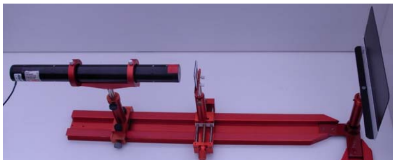
Esquema do Arranjo Experimental para experimentos com redes de difração
