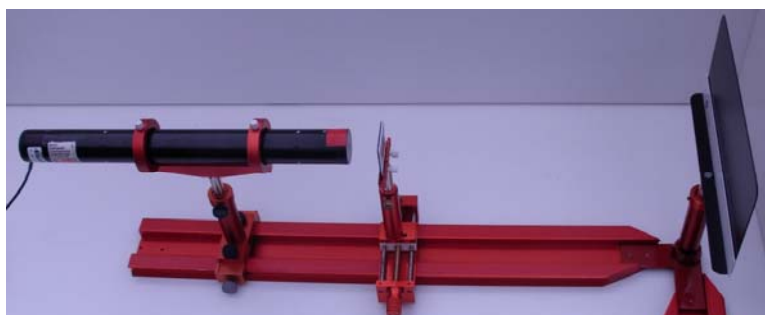
Figura 1 – Esquema do Arranjo Experimental para experimentos com redes de difração
