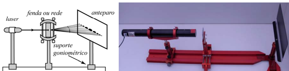
Figura 3 – Esquema do Arranjo Experimental para experimentos com redes de difração
