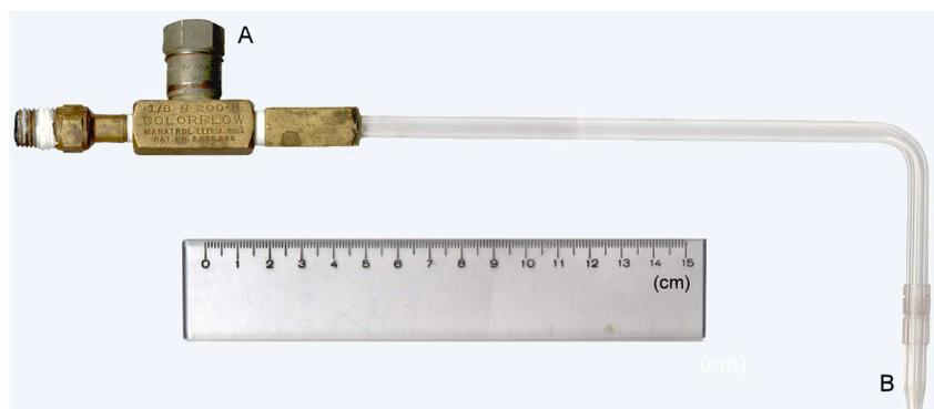
Figura 3.1.4 - A torneira gotejante formada por uma válvula de agulha para gases e um tubo de vidro. A abertura por onde saem as gotas possui 3mm de diâmetro. A - eixo sextavado de comando da válvula. B - bico da torneira encaixado ao tubo de vidro por uma mangueira plástica.
