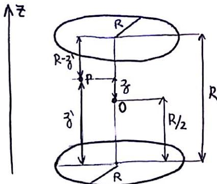
Para calcular o campo no ponto P (fig), só precisamos somar o campo gerado pela bobina de cima (a uma distância  $R-z'$ ) com o gerado pela bobina de baixo (a uma distância  $z'$ ).
